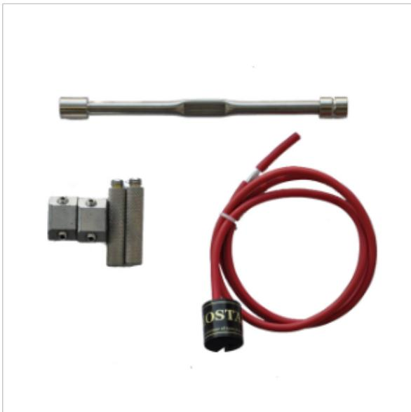
埋入式应变计是坚固耐用的不锈钢结构，不受电磁干扰[EMI]、射频干扰[RFI]和雷击的影响[EFO]。应变计是为埋入混凝土而设计的。埋入式应变计有两种不同的方式安装在混凝土结构中：把它直接埋入到新拌混凝土拌合物中，或者先把它封装在混凝土成型试块中然后再把试块浇筑到新拌混凝土拌合物中。用灌浆的方法把EFO或埋有EFO的试块浇筑到一个预钻的孔中，这样就可以把EFO固定在硬化混凝土中。埋入式应变计可用于不同类型的混凝土，包括普通混凝土和高性能及粉末活性混凝土。上海振弦式表面应变计埋入式振弦应变计易于安装和使用。
