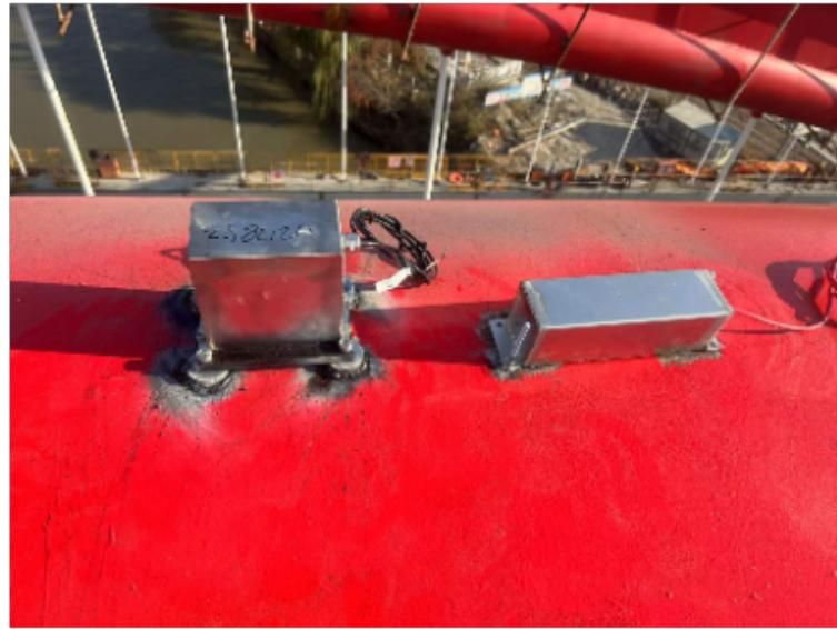
将电阻应变计安装在构件表面，在应变计轴线方向的单向应力作用下，敏感栅的电阻变化率和引起此电阻变化的构件表面在应变计轴线方向的应变之比，称为电阻应变计的灵敏系数 $K$ 。它表示电阻应变计输出信号与输入信号在数量上的关系，是电阻应变计的主要工作特性之一。敏感栅的栅长一般为0.2~100毫米，电阻为60~1000欧（较常用的为120欧和350欧），测量范围为几微应变至数万微应变（1微应变=10<sup>-6</sup>毫米/毫米）。看了上文的介绍后希望能帮助到你。应变计检查包括外观检查和阻值检查。上海振弦式表面应变计
